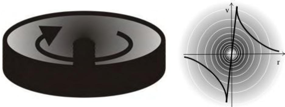
Рис. 2.3. Изменение линейной скорости в вихре
